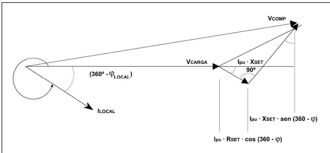
Figura 3.1.8: Compensación de la caída en la línea: LDC-R&X.
