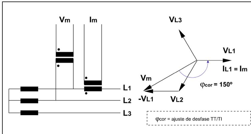
Figura 3.1.1: Ejemplo 1 de ajuste del desfase TT/TI.
