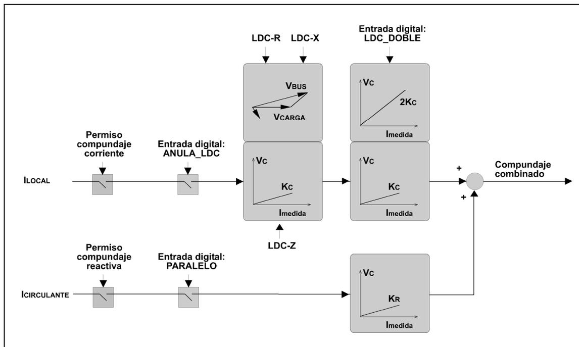
Figura 3.1.11: Compundaje combinado y compundaje máximo.
