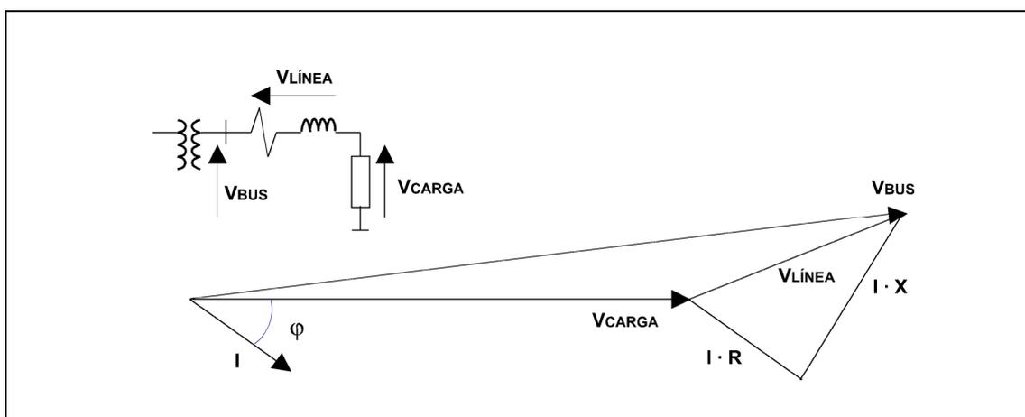
Figura 3.1.7: Compensación de la caída en la línea (LDC).
