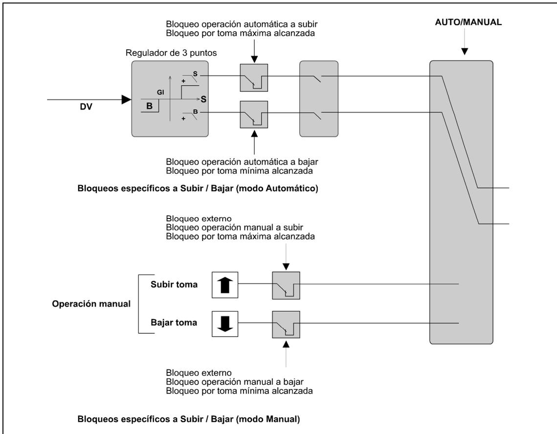
Figura 3.1.17: Bloqueos específicos a Subir / Bajar (modos Automático y Manual).
