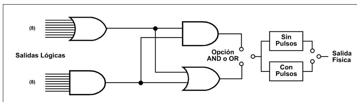
Figura 3.11.2: Diagrama de bloques de la celda lógica asociada a cada una de las salidas físicas.
