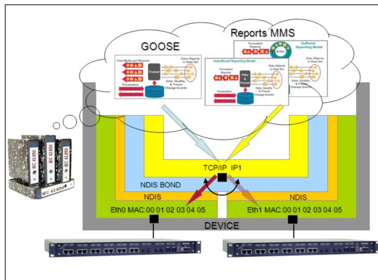
Figura 3.13.2: Configuración de los puertos de comunicaciones para el modelo con redundancia tipo Bonding.
