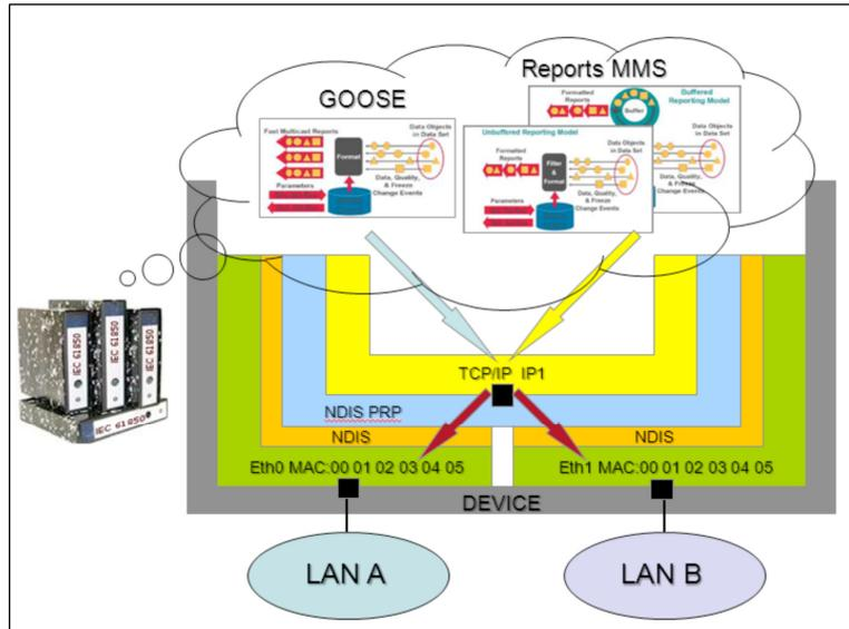
Figura 3.13.3: Configuración de los puertos de comunicaciones para el modelo con redundancia tipo PRP.
