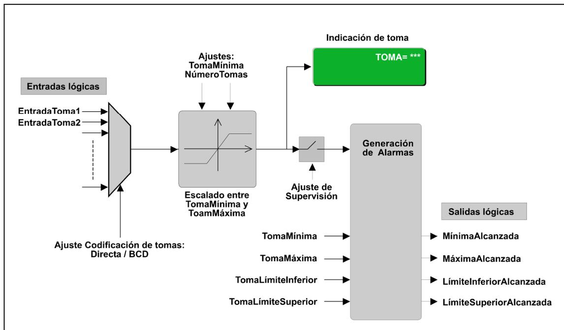
Figura 3.1.14: Representación esquemática del ajuste de supervisión de tomas.
