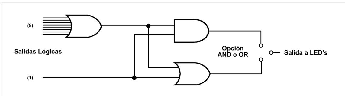
Figura 3.11.3: Diagrama de bloques de la celda lógica asociada a cada una de las salidas que actúan sobre los LEDs.
