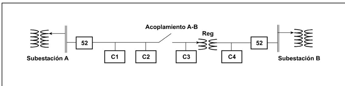
Figura 3.1.18: Esquema de la inversión del flujo de potencia.
