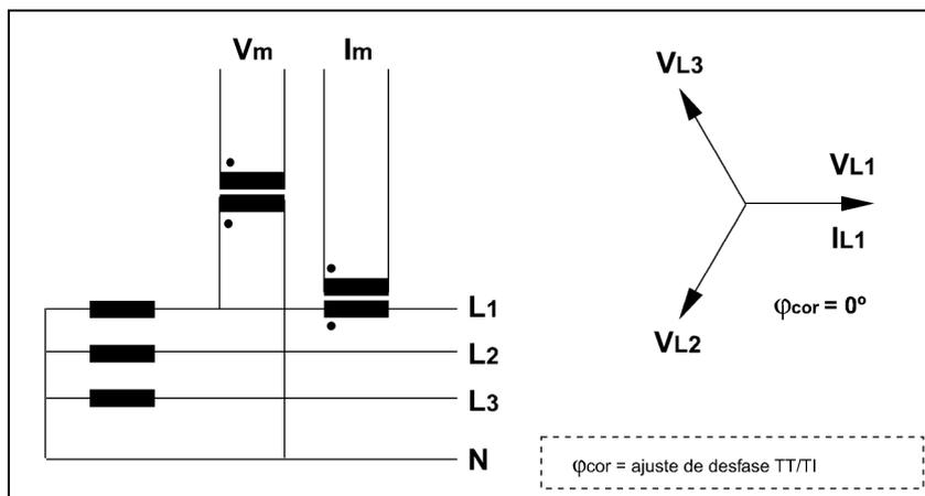
Figura 3.1.2: Ejemplo 2 de ajuste del desfase TT/TI.
