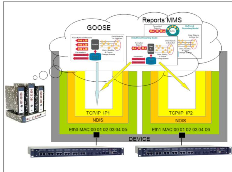
Figura 3.13.1: Configuración de los puertos de comunicaciones para modelos sin redundancia de Ethernet.
