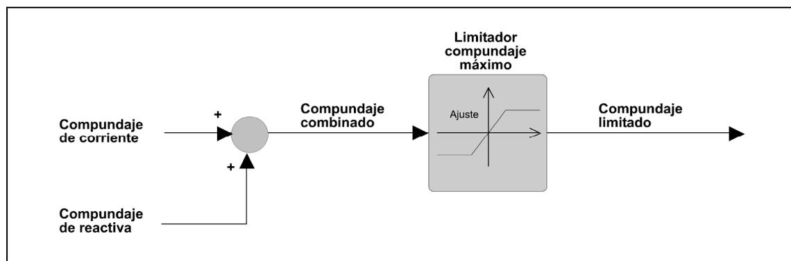
Figura 3.1.12: Ajuste de compundaje máximo.
