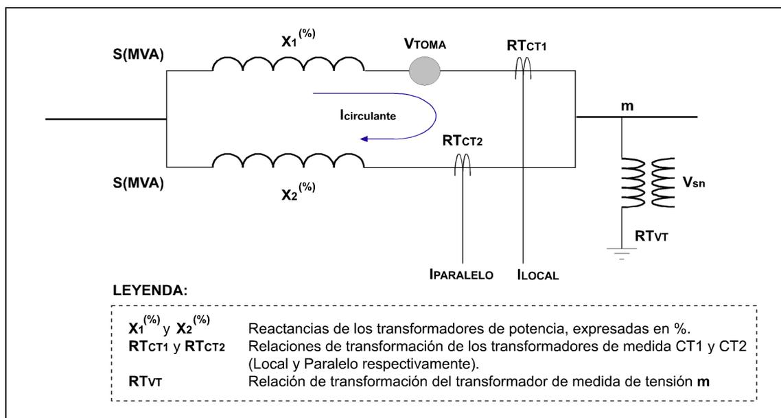
Figura 3.1.9: Esquema de dos transformadores trabajando en paralelo y con diferente impedancia.
