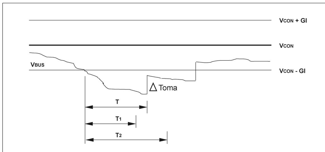
Figura 3.1.15: Bloqueo por tensión fuera de rango.
