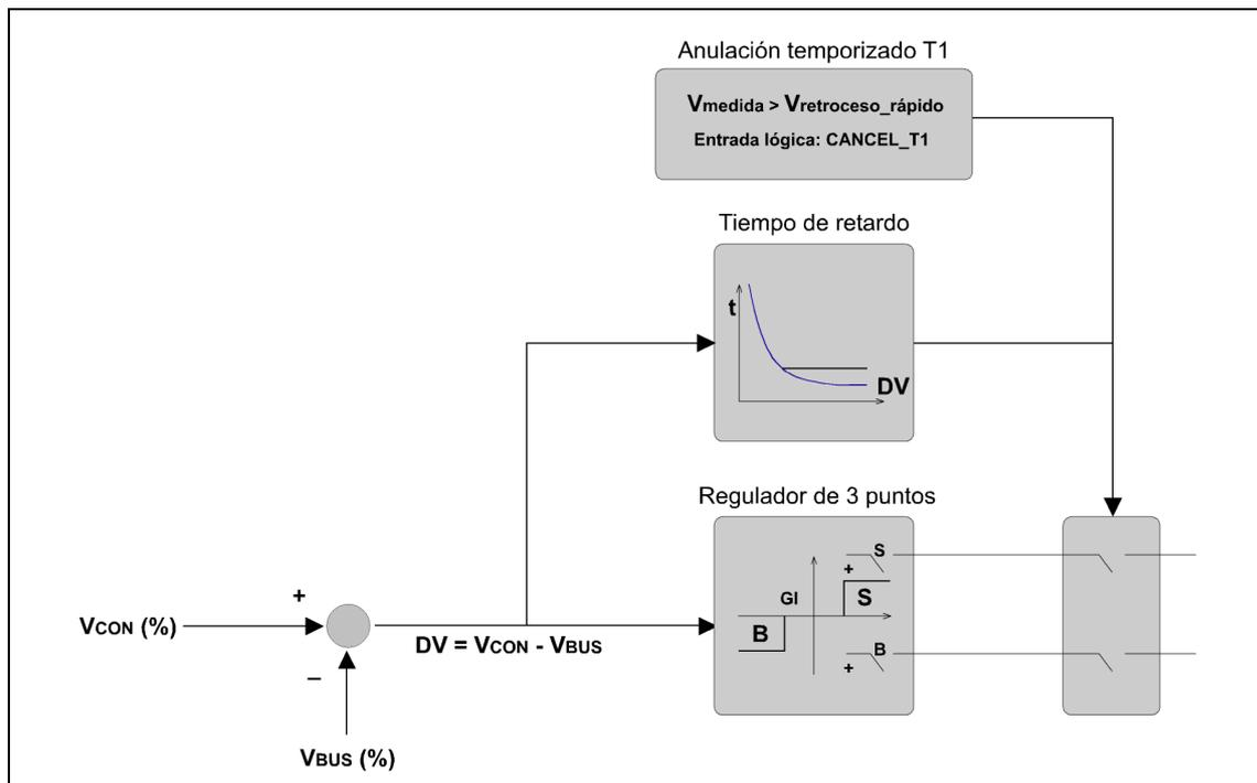
Figura 3.1.4: Representación esquemática de subir / bajar toma.
