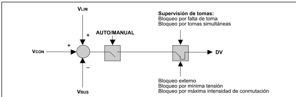
Figura 3.1.16: Bloqueos en el lazo principal del regulador (modo automático).
