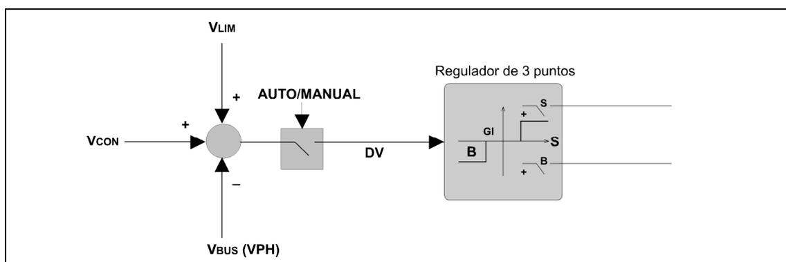
Figura 3.1.13: Lazo principal del regulador (modo automático).
