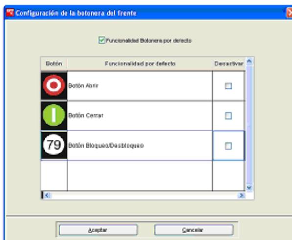
Figura 1.3.6: Configuración de los botones de mando
