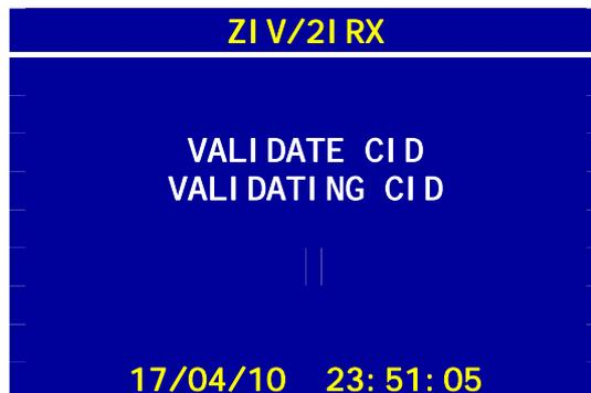
Una vez validado, el equipo activará el nuevo **CID**, realizando un proceso de backup y reinicio, rearrancando las comunicaciones y utilizando el nuevo **CID**.
